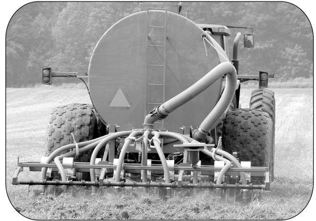
Figure 2. Citerne dotée d'une rampe d'épandage et d'unités d'injection de biosolides provenant d'égout et de fumier liquide.
